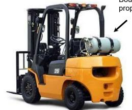
Le moteur du chariot élévateur à gaz utilise la combustion du propane comme source d'énergie.
